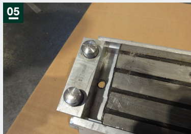
05: An der Demontageposition stoppen und den Block per Hand entnehmen
