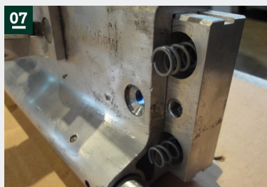
07: Neuen Fußblock in Führung einsetzen
