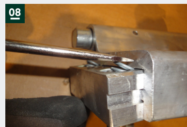
08: Federn vorsichtig komprimieren und in den Block einschieben
